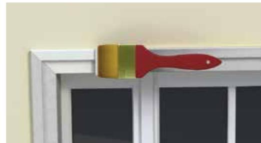
**[7C]** Noyer la tête de la vis à l'intérieur de la moulure avec la colle DOMOSTYL® XF250. Pour enlever les taches de colle DOMOSTYL® XF250 sur les produits ainsi que sur les outils, utiliser du white spirit.
